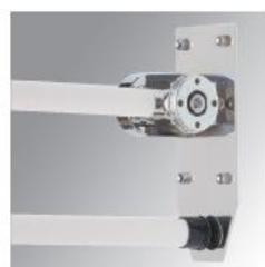
収納位置(垂直位置)では固定されておりますが、手前に引くことで解除され、特殊ダンパー内蔵により、使用位置(水平位置)まで緩やかに手すりを降下させることができます。面倒なレバー操作等を必要としないシンプルで安全な補助手すりです。
